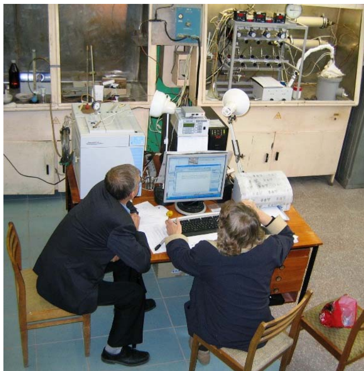
Современная автоматизированная установка на давление 20 ати для тестов промышленных катализаторов окиси этилена с «однорядным» реактором. ООО «Оксит», у «кнопок» А.Н.Парфенов и Г.А.Козлова
